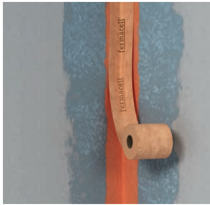
Application de la bande de pontage dans la première couche de SPEC encore fraîche et passe de la seconde couche de SPEC sur la bande mise en place.
